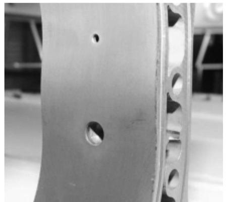
Doppelzündung, die Wasserkanalabdichtung wurde wieder in die Trochoiden verlegt.
