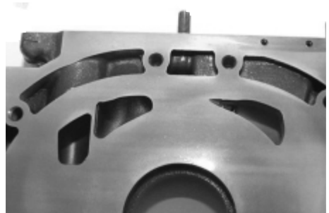
Blick auf ein Seitenteil mit Wasserkanälen außen und zwei Einlasskanälen links und dem neuen Auslasskanal rechts.
