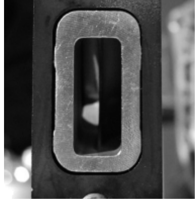
Der Auslasskanal ist in den Seitenteilen und mit Keramik ausgekleidet.
