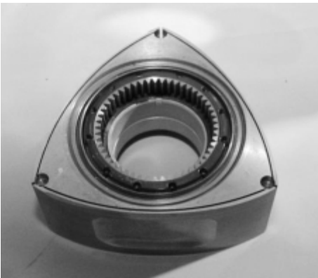
Der Läufer ist leichter und hat ein optimiertes Abdichtsystem
